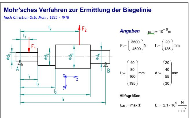
Generell muss zunächst je eine Funktion für das Biege- und axiale Flächenmoment 2. O. in Abhängigkeit von z (Abstand vom Bezugs-Lager) definiert werden.
