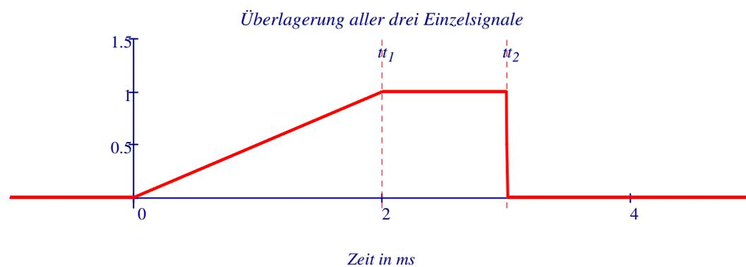
Wenn es uns nun gelingt, die Systemreaktionen auf die Rampe (die sogenannte *Rampenantwort*) und auf den Sprung (die *Sprungantwort*) zu berechnen, dann können wir (ein LTI-System vorausgesetzt!) das Ausgangssignal als Überlagerung zweier Rampenantworten und einer Sprungantwort analog zum Eingangssignal anschreiben, nämlich in der Form:
