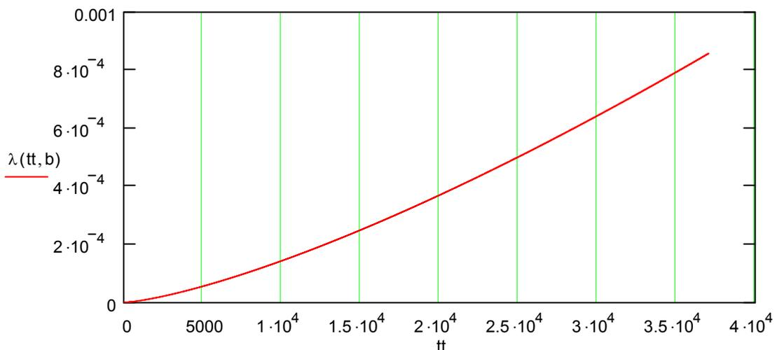
Die obige Kurve zeigt, dass die Ausfallrate der Energiesparlampen mit der Zeit ZUNIMMT. Dieses Verhalten ist typisch für Produkte, welche einem Verschleiss in Abhängigkeit von der Zeit unterliegen. Dies ist wiederum typisch für Lebensdauerverteilungen mit einer Ausfallssteilheit  $b > 1$ , welche typischerweise für Produkte in Phase III der sogenannten "Badewannenkurve für die Ausfallrate  $\lambda(t)$ " gilt.
