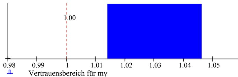
Der als "wahrer Wert" angenommene Wert von 1,00 mg Alkoholgehalt pro Liter liegt ausserhalb des Vertrauensbereiches für  $\mu$  (siehe obige Skizze!). Das bedeutet, dass unser Gerät einen offenbar zu großen Wert misst, d.h. einen systematischen Fehler aufweist. Diese Aussage wird mit einer Irrtumswahrscheinlichkeit kleiner als 1% getätigt.
