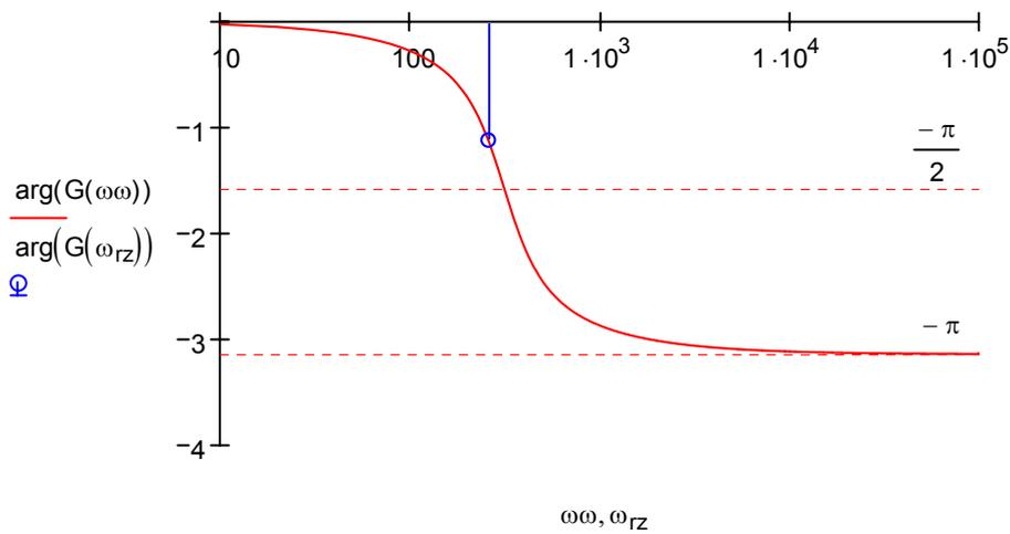
Vergleich mit der Ortskurve (eingezeichnet ist der Punkt der Resonanzüberhöhung - also jenes Wertes, der am weitesten vom Koordinatenursprung entfernt ist - das bedeutet, dass der Betrag maximal ist !!!)
