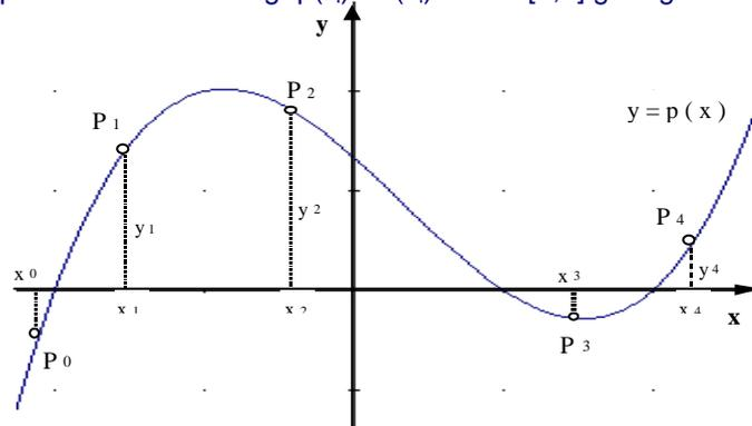
Am Graph des Interpolationspolynoms bemerkt man, daß zwischen den Stützstellen relativ große Schwankungen auftreten. Diese „Welligkeit“ wird um so größer, je mehr Stützstellen vorhanden sind. Durch diese großen Schwankungen sind derartige Polynome zu Weiterbearbeitung (z. B. numerische Differentiation) nicht geeignet.
