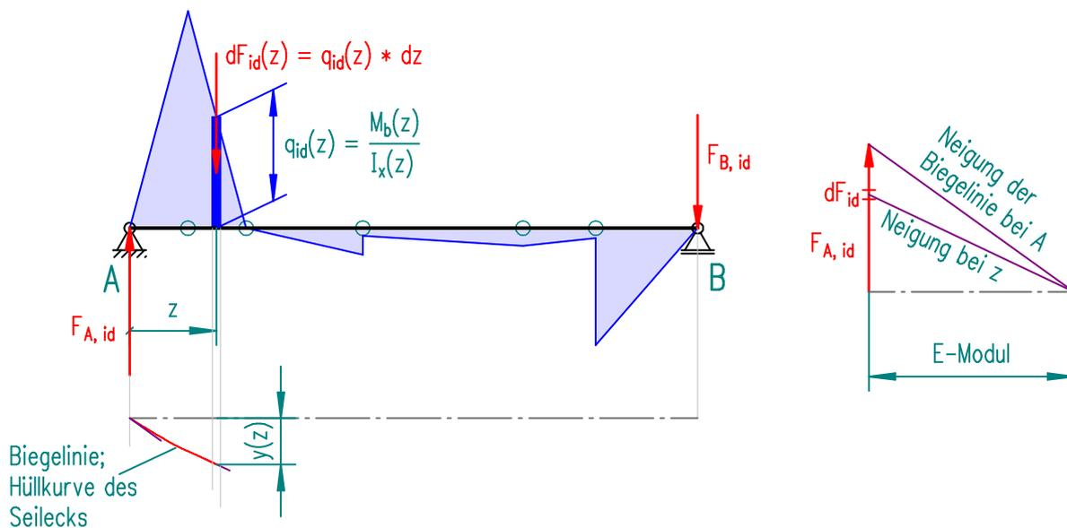
Nach dem Seileckverfahren ergeben sich aus allen  $dF_{id}$  die ideellen Auflagerkräfte  $F_{A,id}$  und  $F_{B,id}$ . (Letztere wird für die weitere Vorgangsweise nicht benötigt.)
