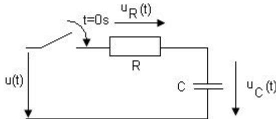
Herleitung der Spannung am Kondensator.
