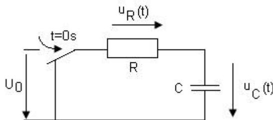
Zunächst wird wieder mit Hilfe der Maschenregel der Zusammenhang der einzelnen Spannungen dargestellt.
