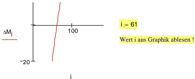
Der Nulldurchgang der Kurve ist der gesuchte Index für die richtige Stahldehnung
