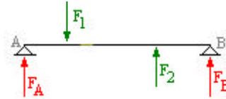
Durch ansetzen der Gleichgewichtsbedingungen in der Ebene erhält man ein Gleichungssystem mit 2 Unbekannten. Dieses wird dann mit der Funktion Suchen aufgelöst. Das Ergebnis stellt die Auflagerreaktionskräfte dar.
