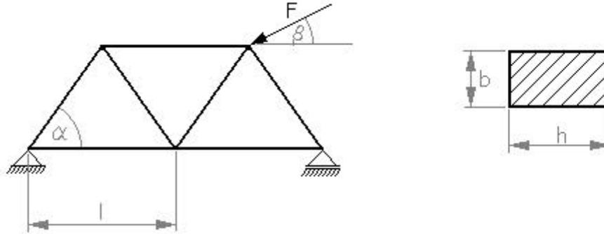
Unser Fachwerk besteht aus drei gleichschenkeligen Dreiecken. Es ist an der linken unteren Ecke mit einem zweiwertigen Lager (Festlager) und in der rechten unteren Ecke ein einwertiges Lager (Loslager) starr gelagert. Die Belastung wird durch die schräge Kraft rechts oben eingeleitet.
