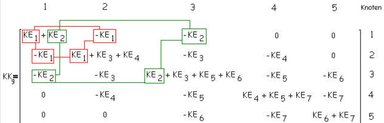
Die Elementsteifigkeitsmatrix wird in der Form von Gleichung 20 eingetragen, wobei die beiden Spalten die Knoten darstellen an denen das Element fixiert ist.
