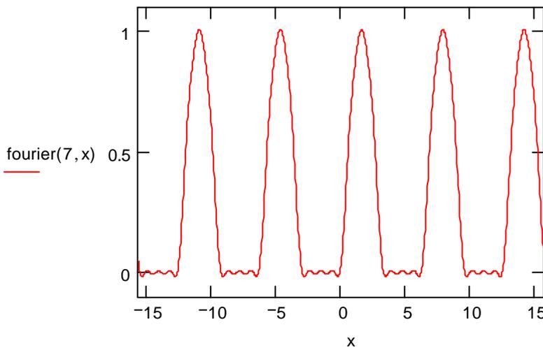
Für die Einweggleichrichtung soll die Güte der Näherung in Abhängigkeit vom Summenindex n, also der höchsten auftretenden Frequenz, demonstriert werden. Dazu wird zuerst der Graph für n = 20 gezeigt, und sodann die absoluten bzw. relativen Abweichungen für verschiedene Argumente x der Fourierreihe von der zu entwickelnden Funktion angegeben.
