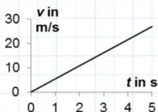
Aus dem Diagramm liest man  $\Delta t := 5 \text{ s}$  und ungefähr  $\Delta v := 27 \frac{\text{m}}{\text{s}}$  heraus.
