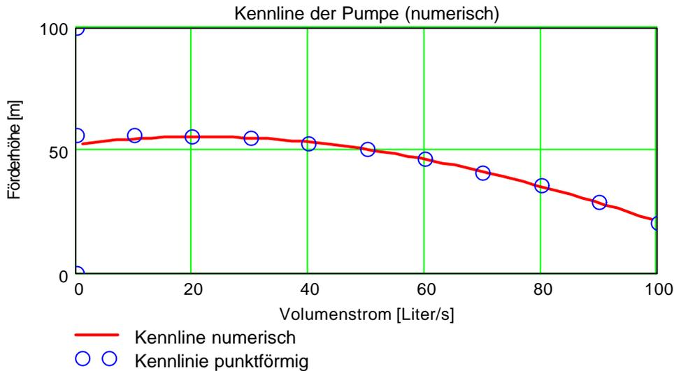
**Anm:** Ausprobieren, ob die Anpassungsfunktion entspricht: Eingabe eines Volumenstroms "zwischen" den Stützpunkten und Kontrolle anhand der Kennlinie im Diagramm der Fa. Vogelpumpen
