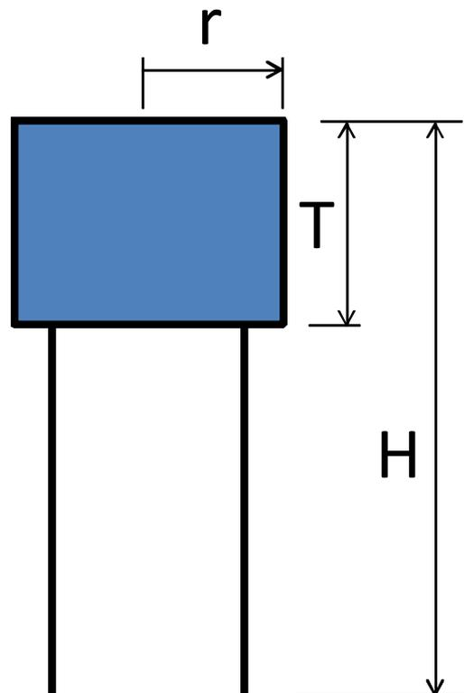
Die Zylinderquerschnittsfläche ( $A_1 := r^2 \cdot \pi$ ) ist  $A_1 = 19.635 \text{ m}^2$ , das Volumen im Zylinder ( $V_Z := A_1 \cdot T$ ) beträgt  $V_Z = 64.795 \text{ m}^3$ .
